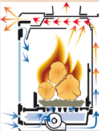
Εικόνα 10. Γραφική απεικόνιση της λειτουργίας ενός ενεργειακού τζακιού
