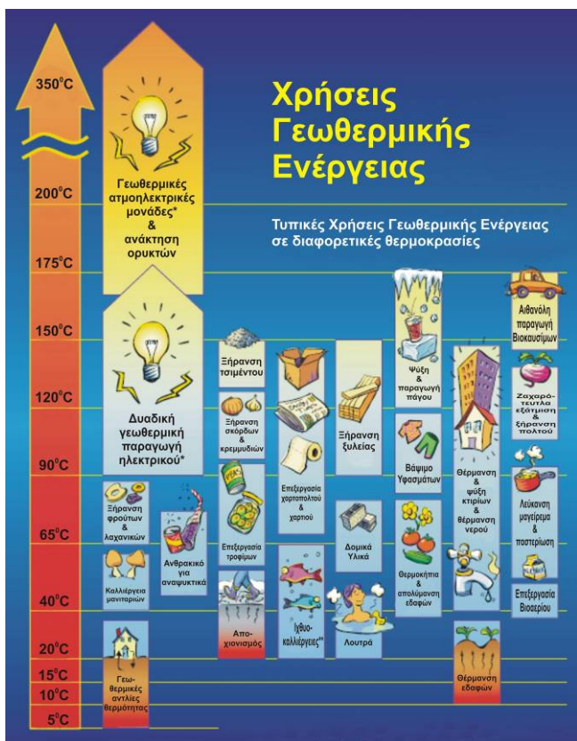
Εικόνα 1. Χρήσεις Γεωθερμικής Ενέργειας [Πηγή: Geothermal Education Office 2004- www.geothermal.mariner.org ]
