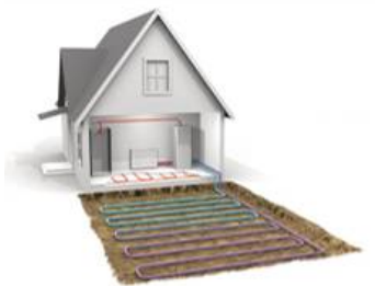
Εικόνα 7. Σχηματική απεικόνιση εγκατάστασης οριζόντιου Γεωθερμικού κυκλώματος
