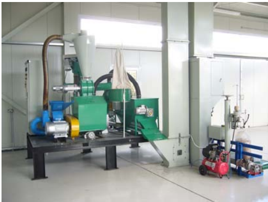
Πιλοτικό Σύστημα Παραγωγής Πελετών από βιομάζα για χρήση ως στερεά καύσιμα
